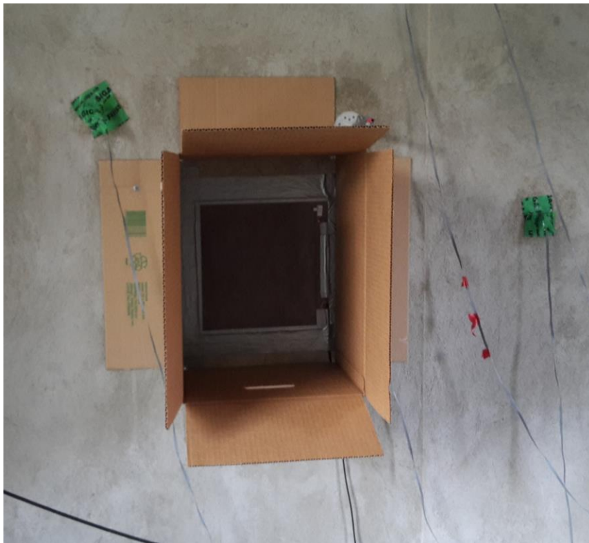
Attēls 1. Pret mainīgajām gaisa plūsmām no ventilācijas iekārtas aizsargātie siltuma plūsmas sensori.
