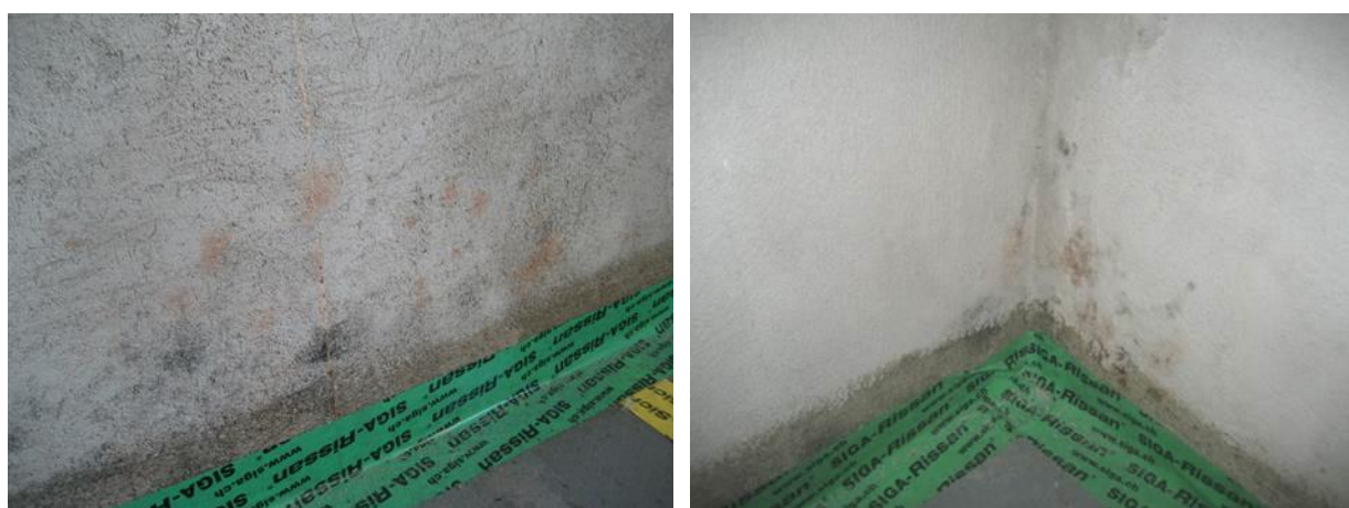
Attēls 7. Ar pelējuma sēnīšu kolonijām klātās virsmas AER stendā, kur tika ņemti paraugi.
